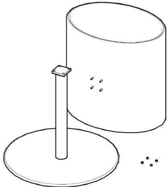
Impostare la parte superiore in modo tale sulla piastra di montaggio del base, che le viti sul fondo della parte superiore inserirsi nei fori della piastra di montaggio.
