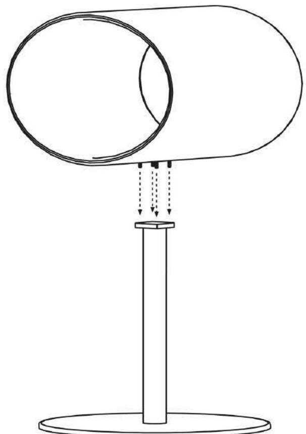
Ora avvitare i dadi in senso orario sulle viti e stringere saldamente con una chiave taglia 10 (sistema metrico).
